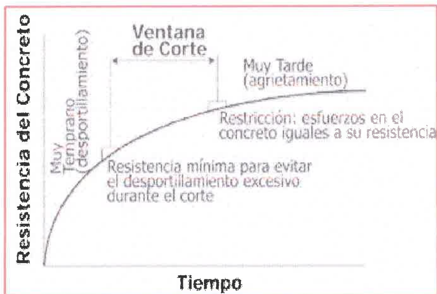
Figura 3: Gráfica de la resistencia del concreto para su corte
